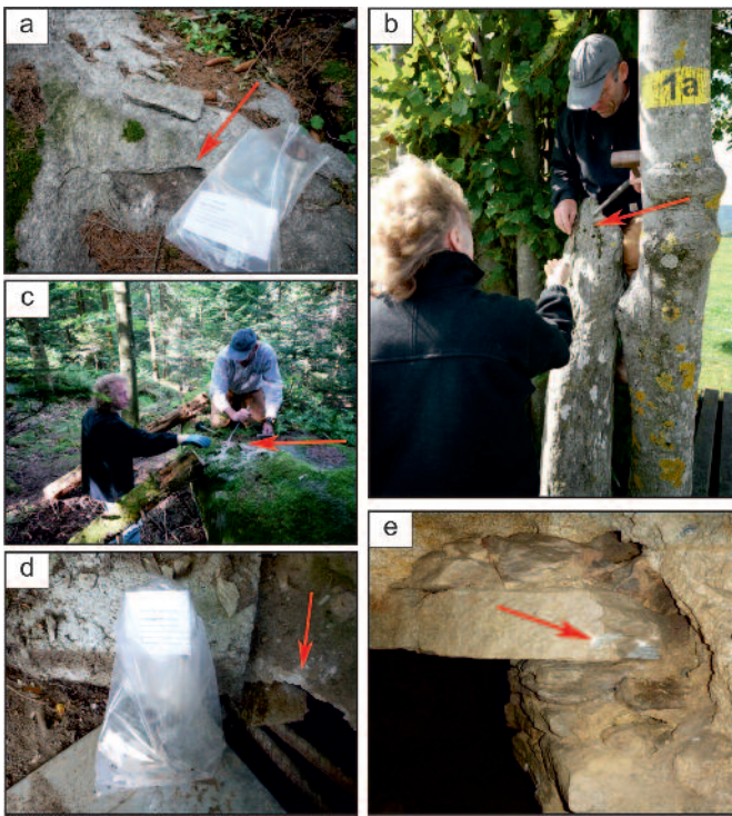
Abb. 26: Fotos der Probenstellen des ersten Probenlaufs. Die roten Pfeile zeigen den Punkt der genommenen Probe. a) Probenahme auf der bearbeiteten Oberfläche beim sogenannten "Steinbruch" am Pongrazer Kogel; Position: 47°20'30,0" N; 15°54'20,5" E. (siehe auch 2. Probe von dieser Lokalität auf Abb. 23). b) Probenahme beim Lochstein in Sommersgut bei Wenigzell; Position: 47°27'57,6" N; 15°49'12" E, Datenbanknummer 148 (Tabelle 3). c) Das sogenannte „Schiff“, im zweiten Steinbruchareal am Pongrazerkogel; Position: 47°21'25,2" N; 15°54'25,2" E., Foto: Ingrid Kusch. d) Die Franzosenhöhle im Wald bei Miesenbach; Position: 47°24'25,2" N; 15°49'40,8" E. e) Eine unterirdische Trockenmauerpassage im "Grubergang" in Pongrazen; Position: 47°20'16,8" N; 15°54'3,6" E. • Fig. 26: Photos of the sample sites of the first sample run. The red arrows show the point of the sample taken. a) Sampling on the worked surface at the so-called "quarry" on the Pongrazer Kogel; Position: 47°20'30.0"N; 15°54'20.5" E. (see also 2nd sample from this locality on Fig. 23). b) Sampling at the Lochstein in Sommersgut near Wenigzell; Location: 47°27'57.6"N; 15°49'12" E, database number 148 (Table 3). c) The so-called "Schiff", in the second quarry area on the Pongrazerkogel; Position: 47°21'25.2"N; 15°54'25.2" E., Photo: Ingrid Kusch. d) The Franzosenhöhle in the forest near Miesenbach; Position: 47°24'25.2" N; 15°49'40.8" E. e) An underground dry stone wall passage in the " Grubergang " in Pongrazen; Position: 47°20'16.8"N; 15°54'3.6" E. Fotos: a, d - Heinrich Kusch, c, e Ingrid Kusch
