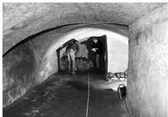
Abb. 48: Geobodenradaruntersuchung im Gruftraum 1, der über 3,5 m hoch mit Bauschutt verfüllt ist
