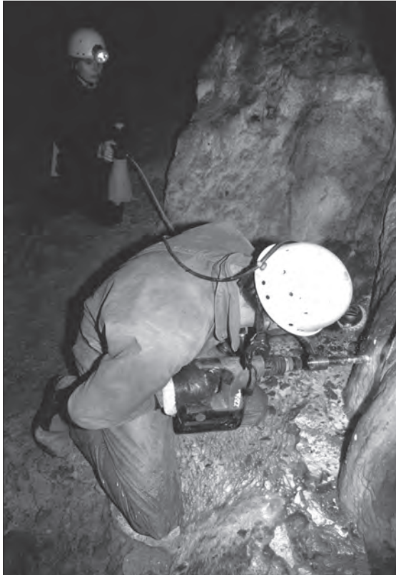
Abb. 6: Kernbohrung an einem bearbeiteten, teilweise mit Jungsinter überzogenen Wandteil. Foto: H. Kusch.
